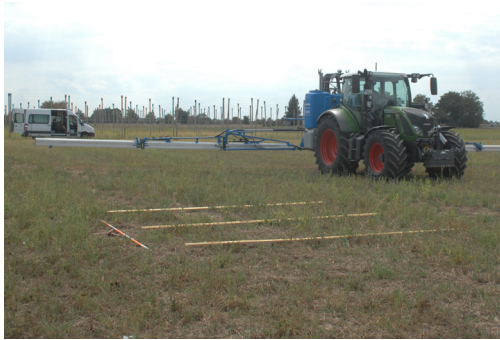
Bild 3: Für die Versuche zur automatisierten Umsetzung von Abstandsauflagen wurden auf einer Brachfläche Schutzzone eingemessen. Foto: LTZ/Michael Glaser
