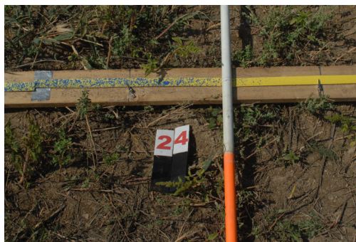
Bild 5: Nach der Überfahrt wurde das wassersensitive Papier überprüft. Es verfärbt sich bei Benetzung mit Wasser blau. Foto: LTZ/Michael Glaser
