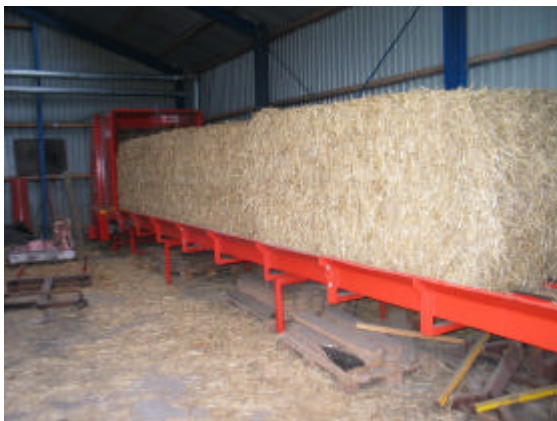
Bild 3: Strohheizung mit Zuführung Quaderballen
