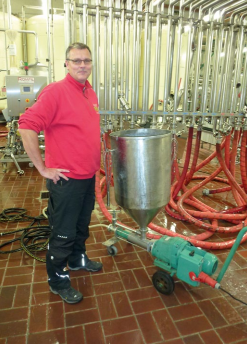
Abb. 7: Dieter Beil von der WG-Heilbronn vor dem Pumpentrichter, in dem die Reinzuchthefen rehydriert und anschließend inline zum Most auf dem Weg zum Gärtank zudosiert werden.
