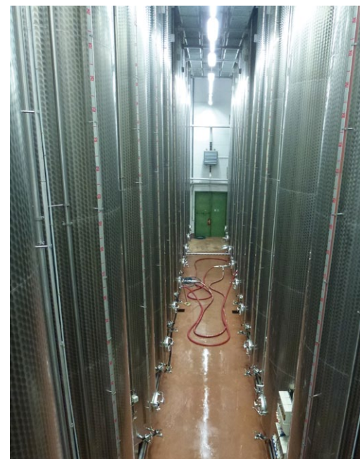
Abb. 6: Gärkeller in der WG-Heilbronn – hier zylindrischen Edelstahl tanks mit je 40 000 l Fassungsvermögen, rund 11 m hoch und mit Wasserberieselung gekühlt.
