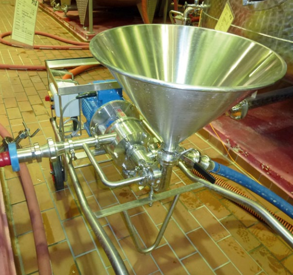
Abb. 10: In-Line Ready Gerät zum Dispergieren von trockenen Schüttgütern in Flüssigkeiten – hier benutzt für Trockenreinzuchthefen.
